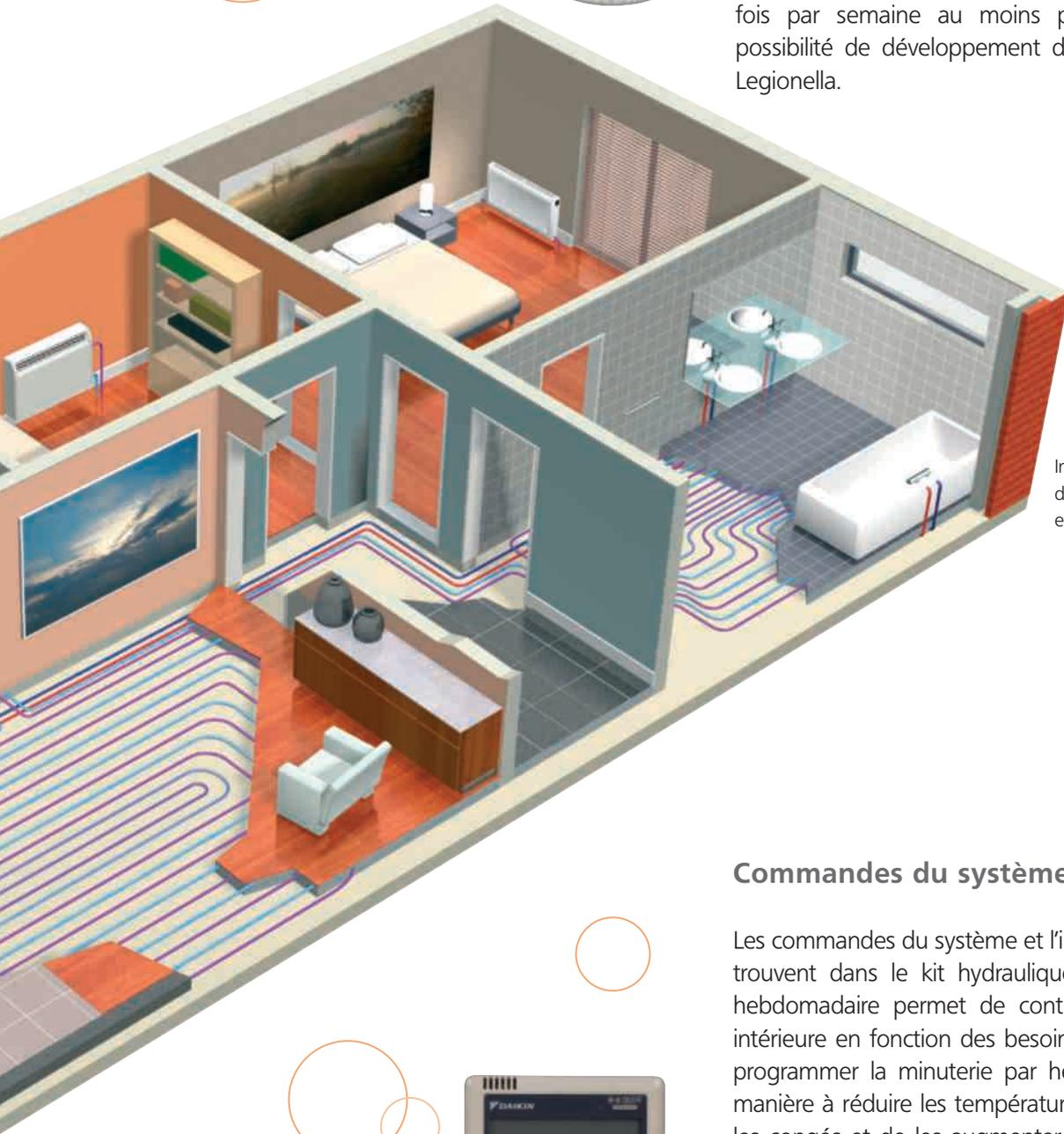
Installation type avec ballon d'eau chaude sanitaire (option) et rafraîchissement.(option)
